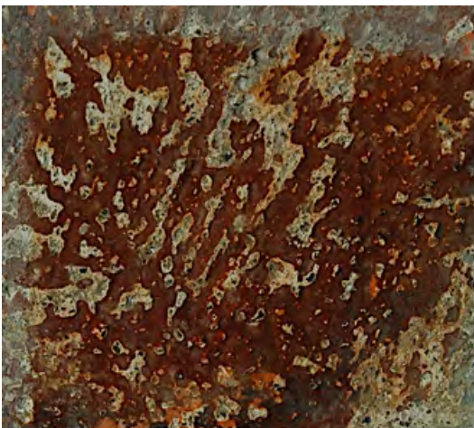
Pinself Applikation: 2% Klucel EF in Azeton, nachreinigung mit Feuchtigkeit
